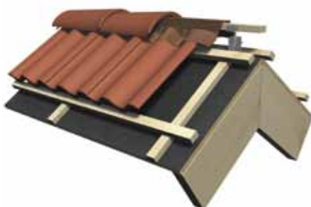
Bild 13. Benders nock och valmtätningssulle är lätt att montera. Rulla ut en längd på nockplankan, spika eller häfta fast den. Ta sedan bort skyddstejpen på undersidan av rullen och tryck fast och forma mot takpannorna.
