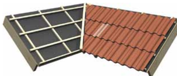
Bild 15. Vid vinkelrännor används halvpannor för att undvika småbitar (endast 2-kupiga). Halvpannan är markerad på bilden. Undvik små skurna bitar som är svåra att fästa. Rita på taket - skär på marken - spola pannorna med vatten direkt efter skärning!
