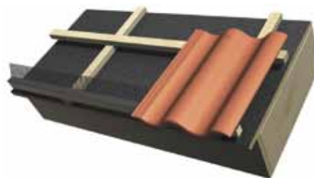
Bild 14. Fågelbandet monteras vid takfoten för att förhindra att fåglar bygger bo under takpannan. Det finns även ventilerat fågelband, används för tak med takfotskil.
